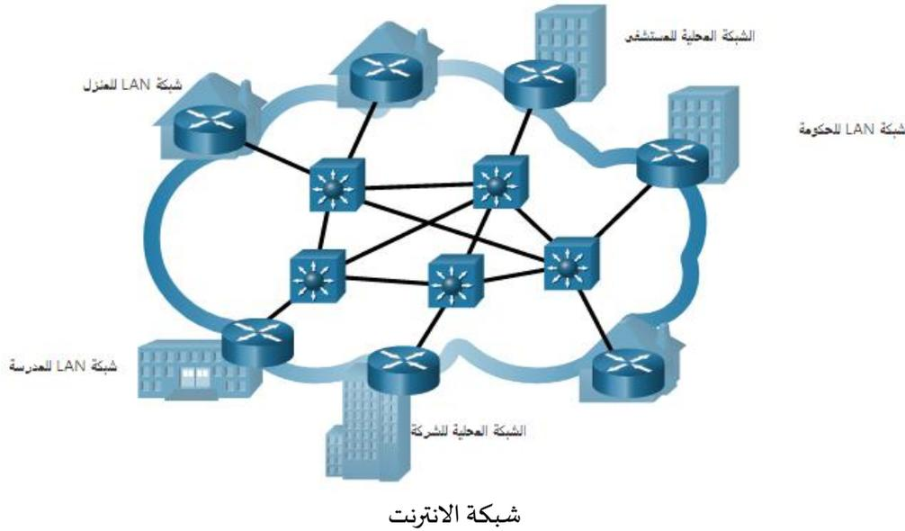
تتصل جميع الأجهزة المشاركة في اتصال الشبكة فيما بينها بواسطة تبادل الحزم (Packets) بإتباع بروتوكول التحكم بالإرسال و بروتوكول الإنترنت الموحد (TCP/IP : Transmission Control Protocol / Internet Protocol). ويتم تعيين رقم لكل جهاز بهدف تحديد/تعريف الجهاز داخل الشبكة، ويسمى هذا الرقم عنوان بروتوكول الإنترنت (IP).
