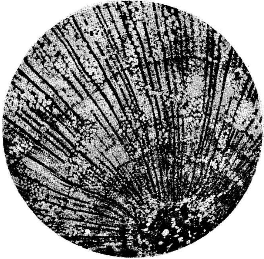
صورة 2 : - صورة فوتوغرافية لشريحة رقيقة من فحم ما قبل التاريخ أخذت بواسطة مكبر (ميكروسكوب) . يسمح تحليل مثل هذه المقاطع بتعريف الفحم .
