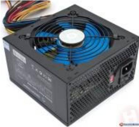
عبارة عن صندوق حديدي يقوم مزود الطاقة بتحويل الطاقة الكهربائية الداخلة (AC) إلى طاقة كهربائية متدنية إلى (12V, 3.3V, 5V)، وتستخدم القوة الكهربائية (5V, 3.3V) في الدائرة
