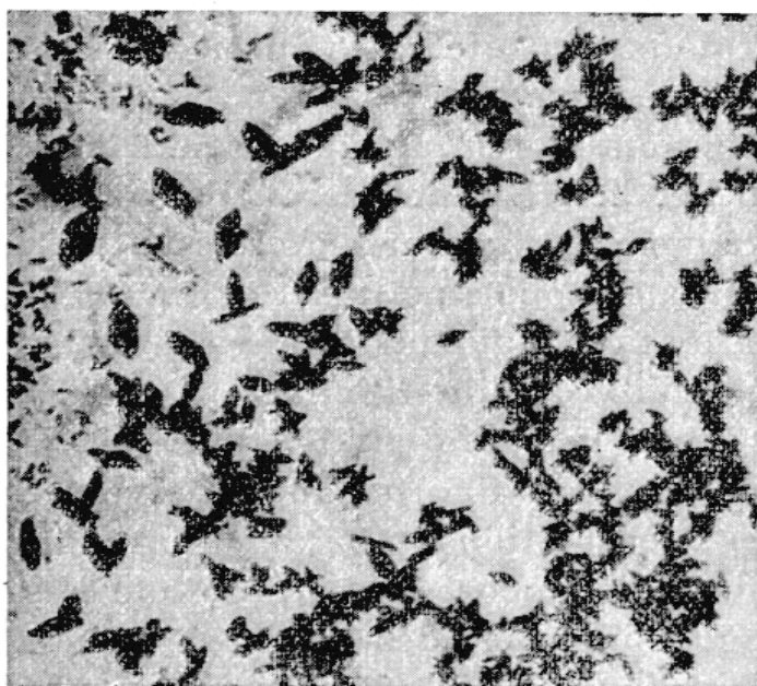
B. Analyse microchi- mique de la soudure des cloisons : cristaux de bi- chromate d'argent (gros- sissement : 400).
