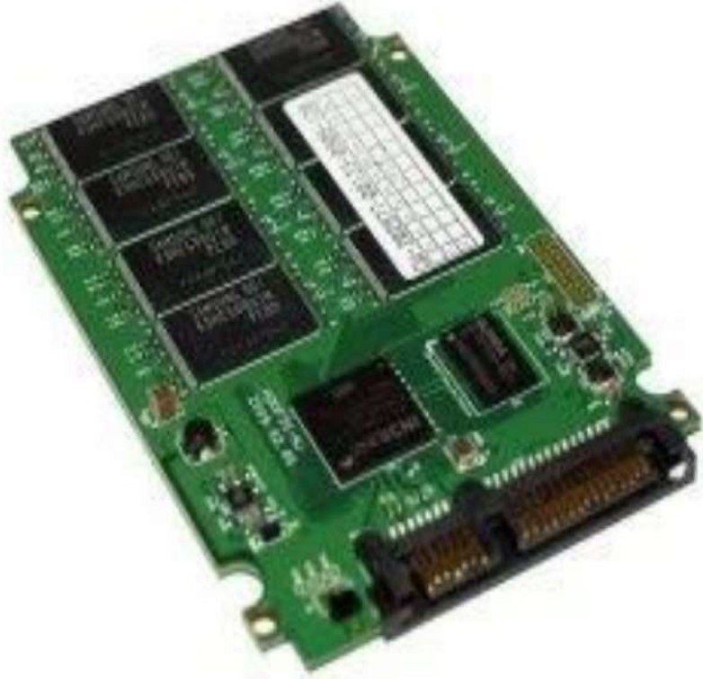
Figure 16 : Vue de l'intérieur du SSD
