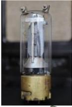
1. **الصمامات المفرغة:** أنابيب زجاجية مفرغة يمكن أن توقف أو تمرر التيار الكهربائي دون الحاجة إلى محول ميكانيكي. يتم استخدامها كمفتاح، أو مكبر للصوت، أو كشاشة العرض في العديد من أجهزة الراديو والتلفزيون وأجهزة الكمبيوتر القديمة وما إلى ذلك. من عيوبها أنها كبيرة الحجم وسهلة الكسر، كما أن سرعتها بطيئة جداً وتستهلك مقداراً كبيراً من الطاقة الكهربائية.
