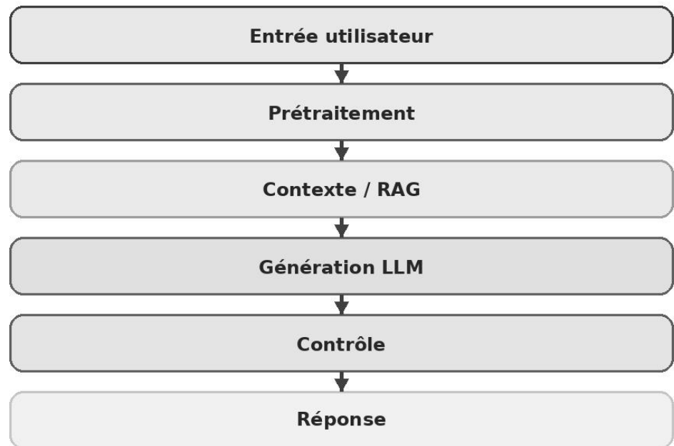
Figure 6.3 — Pipeline complet d'un chatbot moderne
